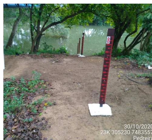
Foto 12 – Visão das réguas limnimétricas no PHJ – 13°C (Data: 30/10/2020).
