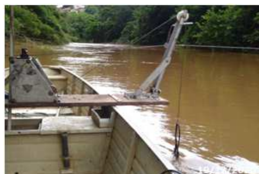
Foto 8 – Detalhe da atividade de medição de vazão no PHJ – 15ª Campanha (Data: 19/12/2020).
