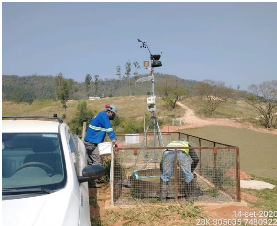
Foto 2 – Realização da atividade de limpeza da EMA. (Data: 14/09/2020).
