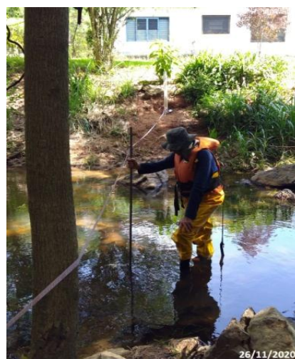
Foto 6 – Coleta de dados com o amostrador de sedimentos PSed. (Data: 26/11/2020).
