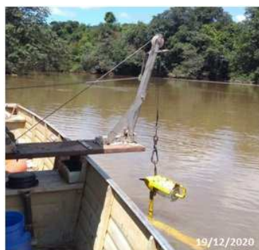
Foto 7 – Vista geral da medição de vazão no PHM – 16ª Campanha (Data: 19/12/2020).
