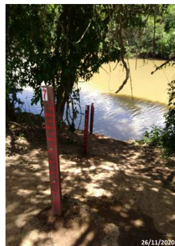
Foto 10 – Visão das réguas limnimétricas no PHM – 15°C (Data: 26/11/2020).
