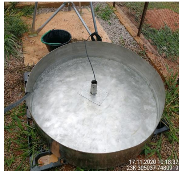
Foto 5 - Tanque do reservatório classe A sendo preenchido com água limpa. (Data: 17/11/2020).
