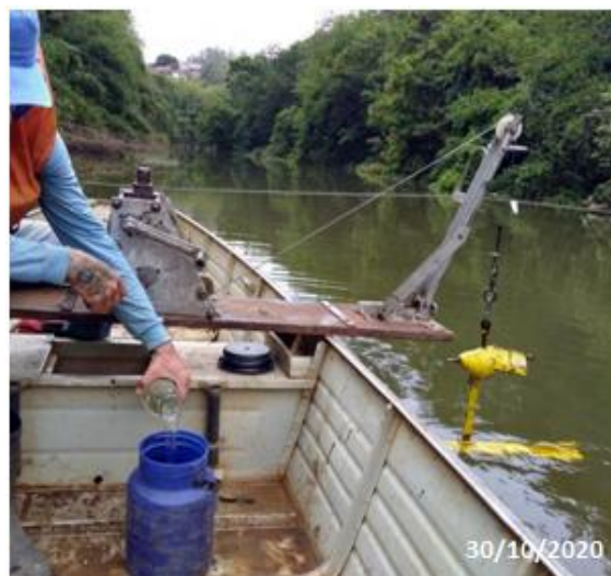
Foto 4 – Coleta de sedimentos em suspensão no PHJ. (Data: 30/10/2020).
