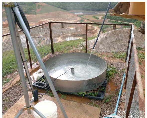
Foto 7 – Reposição de água no reservatório do tanque classe A. (Data: 18/12/2020).
