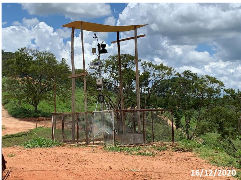
Foto 1 - Estrutura de proteção durante os períodos dos desmontes de rocha. (Data: 16/12/2020).
